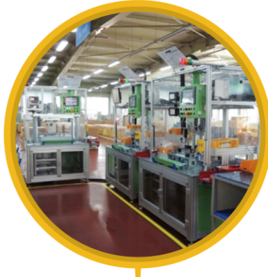
고압펌프 AIR LEAK 검사기
